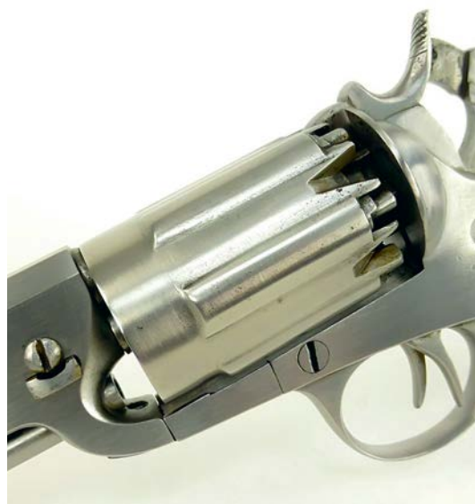
▲ ▼ Револьвер «Уолч Нэви» (Walch Navy). Разработан в США Джоном Уолчем (John Walch). Патент на конструкцию получен в 1859 году. Надпись на револьвере гласит: «Walch Firearms & Co», однако, как это часто бывало в то время, изготавливала револьверы сторонняя подраженная фирма – Union Knife Company
