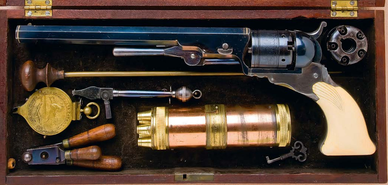
▲ В комплект револьвера «Кольт Патерсон» входят сменный барабан, специальный инструмент для снаряжения барабана, пороховница, пулелейка, шомпол, устройство для хранения капсюлей и снаряжения ими револьвера
