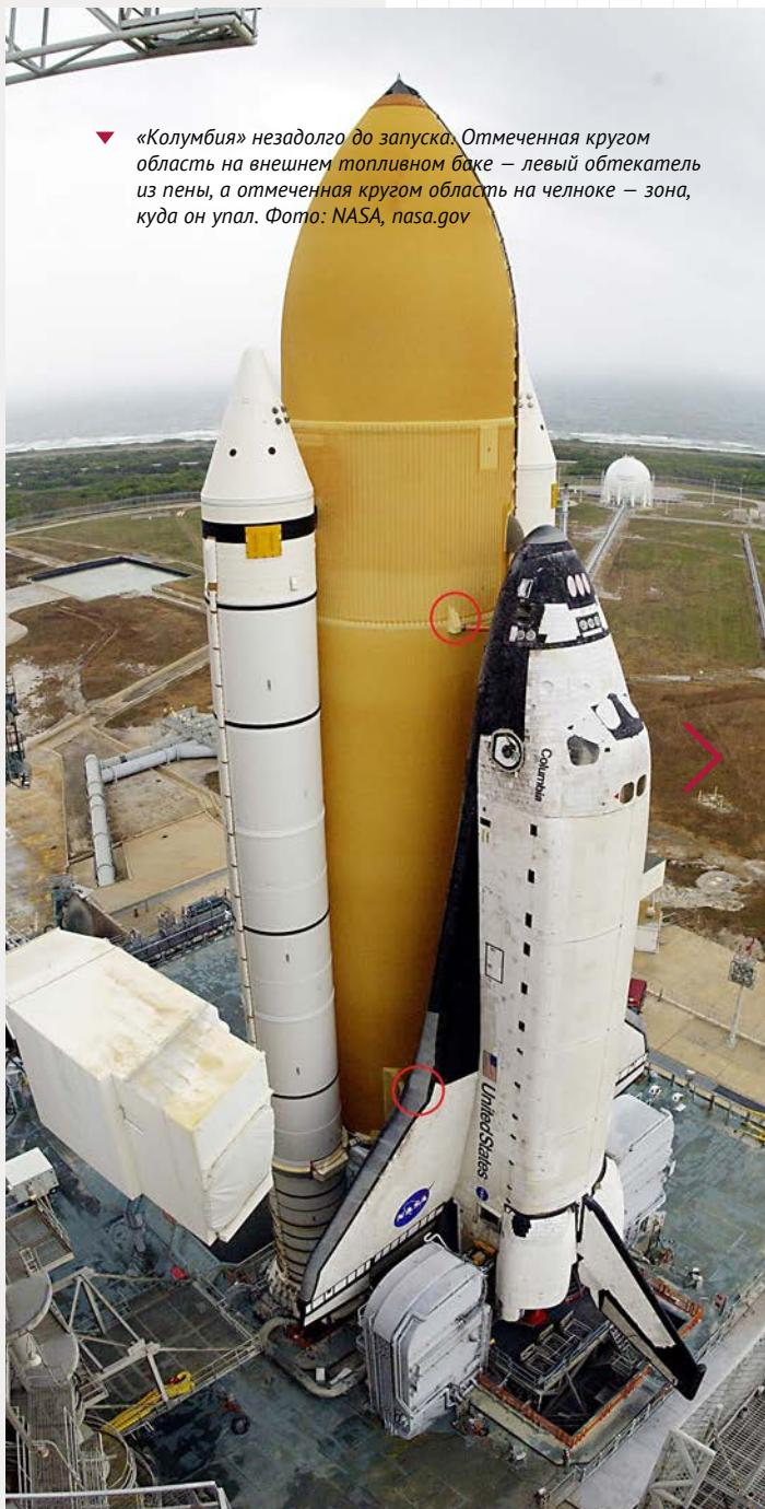
▼ «Колумбия» незадолго до запуска. Отмеченная кругом область на внешнем топливном баке – левый обтекатель из пены, а отмеченная кругом область на членке – зона, куда он упал. Фото: NASA, nasa.gov
